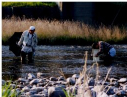
45度の角度で反射鏡を取り付けた測定装置を使って、川の中を水平方向に観測し、水中の黒色板や白色板が、何メートル先まで見えるかを測定
